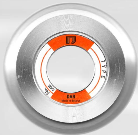
Диски **ДАР6** с алмазным режущим лезвием, осажденным электролитическим методом на алюминиевый корпус, предназначены для разделения на кристаллы пластин из материалов, используемых в микроэлектронике.
